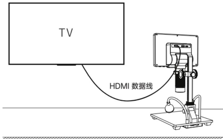
第二步：打开显微镜，你会看到屏幕上的图像，按下遥控器上的拍照和录像按键，照片和视频文件将自动保存TF卡内。
